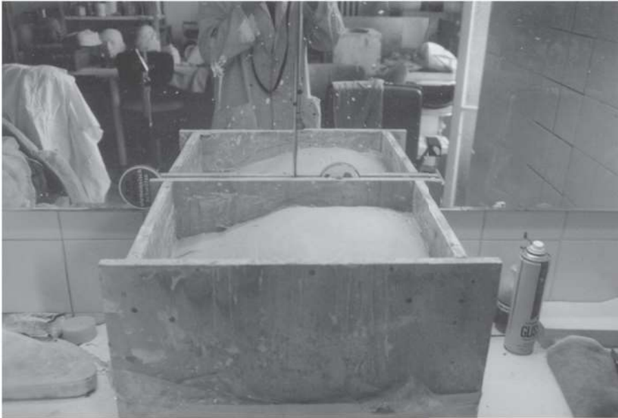
Abtragemehmen vom Positiv, Herstellung einer Negativgipsform mit Hilfe einer Kiste
