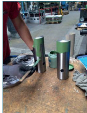
Abbildung D7c1: Vorbereiten einer örtlich begrenzten Wärmebehandlung durch partielles Abdecken der Bauteile.
