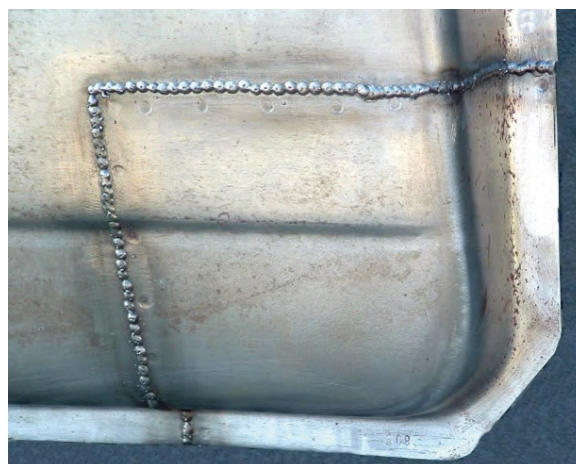
Abbildung: Mittels MAG-Steppnaht eingefügtes Blechteil (Quelle: ZKF)
