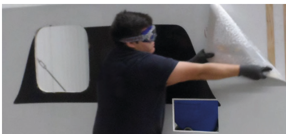
Abbildung: Entfernen des Deckblechs an einer Sandwichplatte (Quelle: P. Lindner, Niesmann Caravanning GmbH & Co KG)
