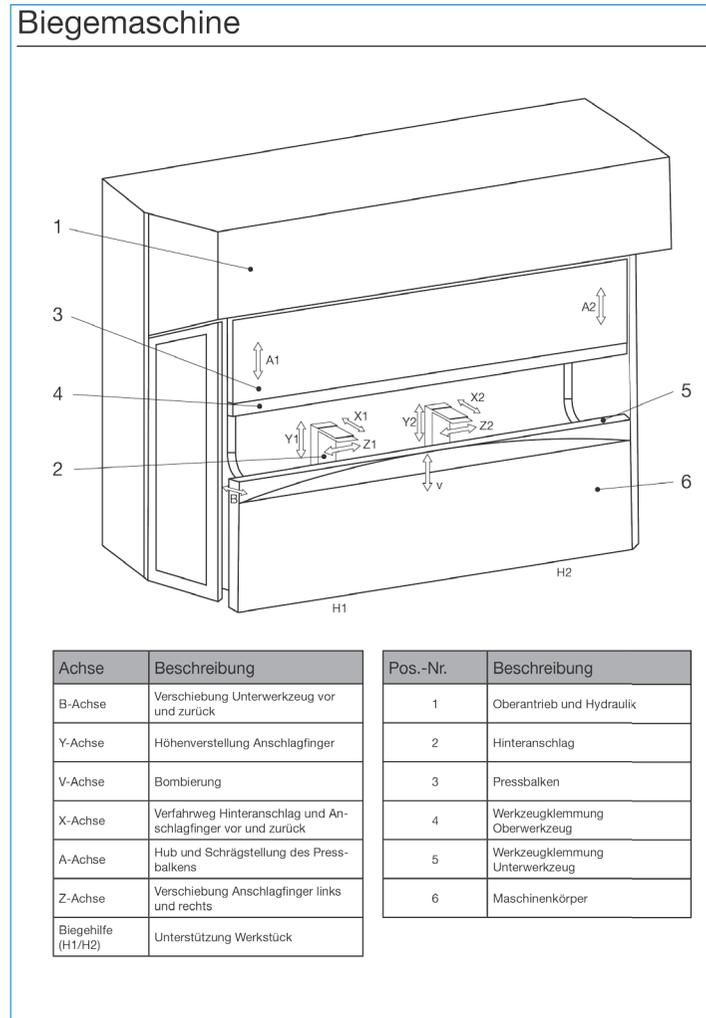
Abb. 14: Biegemaschine © PAL/IHK Region Stuttgart
