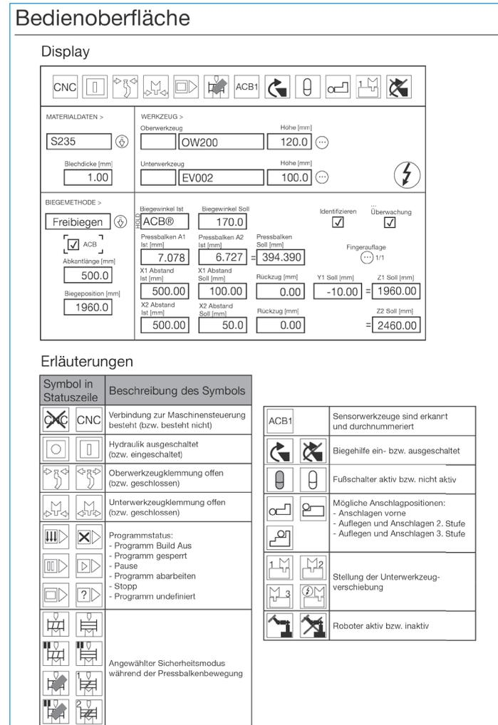
Abb. 15: Bedienoberfläche © PAL/IHK Region Stuttgart
