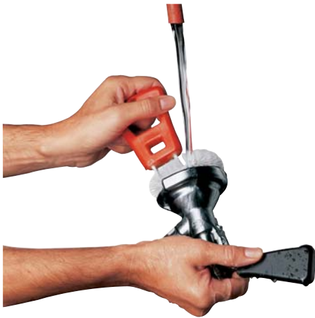
Abb.7: Reinigung Zapfkopf mit spezieller Bürste
