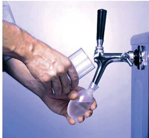
Abb.8: Reinigung Zapfhahn mit Reinigungsball
