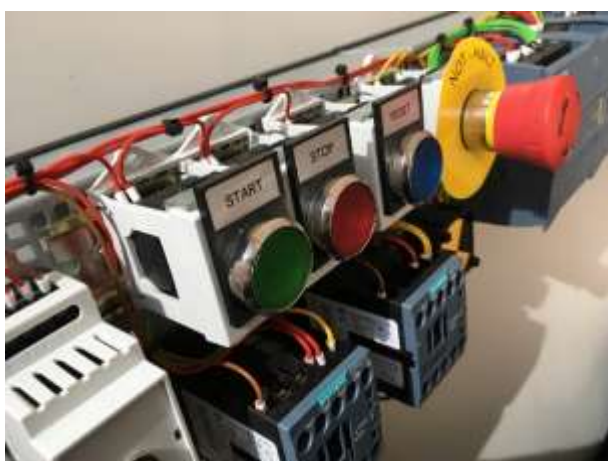
Abbildung 35. Physikalisches Demo-Modell, zusammengestellt als eine Baueinheit auf Basis der Siemens S7-1200F Sicherheits-SPS. Verdrahtet und programmiert auf dem Sicherheitslevel PL d/SIL3 (oben). Vergleich zwischen einem realen physischen Modell (unten, links) und einem digitalen Zwilling in der virtuellen Realität (unten rechts).
