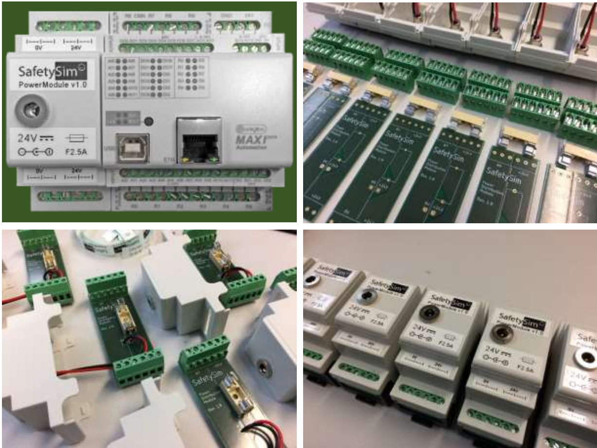
Abbildung 6. Letzte Version des SafetySim-E/A-Adapters (oben links). Prozess der Montage des Stromverteilungsmoduls (oben links, unten rechts). Die Kleinserienproduktion von acht Modulen ist abgeschlossen (unten rechts).
