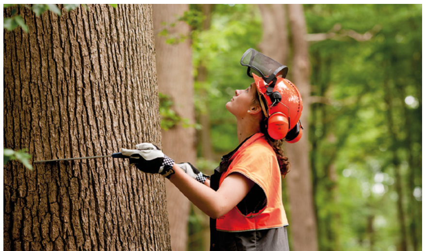
Forstwirtin beim Kluppen (Vermessen) eines erntereifen Baums. Foto: Niedersächsische Landesforsten
