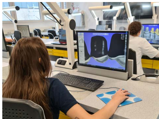
Abbildung 2: Konstruieren von Zahnersatz (Kronen) am Computer (Quelle: Heinrich Wenzel)
