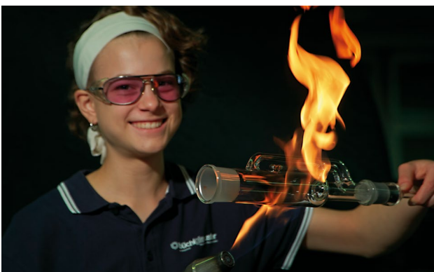
Abbildung 21: Fertigung eines Extraktors nach Soxhlet (Quelle: VDG e. V.)
