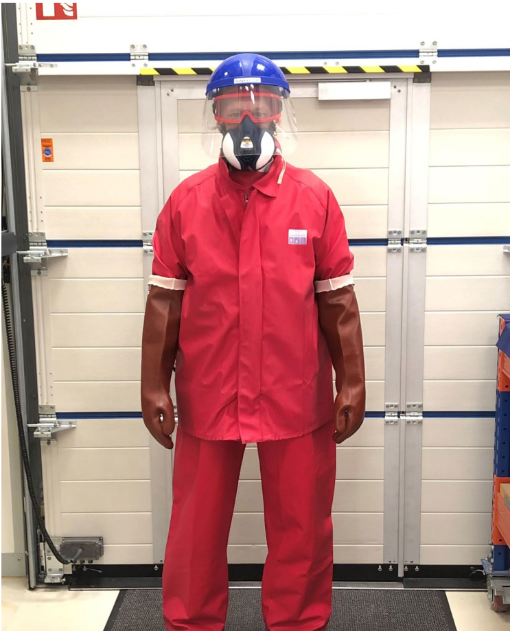
Abbildung 27: PSA bei Arbeiten mit Flusssäure (Quelle: M. Nitzsche)
