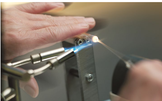
Abbildung 13: Fertigung eines runden Bodens (Ø 5mm) mithilfe von Rollbock und Blasschlauch (Quelle: VDG e. V.)
