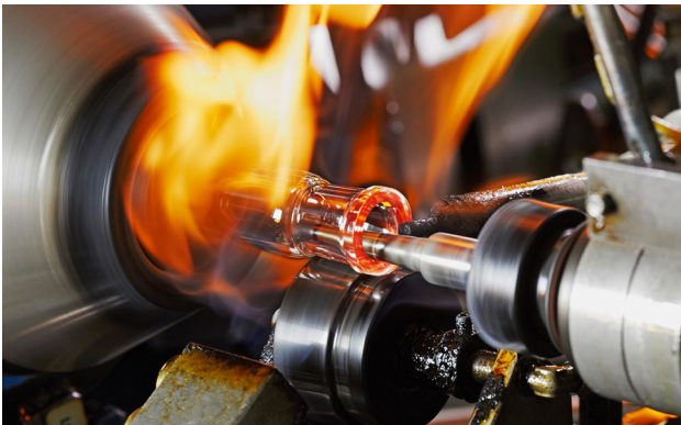
Abbildung 15: Vollautomatische Fertigung einer Normschliffhülse NS 18,8 (Quelle: VDG e.V.)
