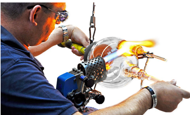
Abbildung 20: Herstellung eines Dreihalskolbens mithilfe eines selbstgefertigten Mehrfachhalters und eines „Galgens“ zur Armentlastung (Quelle: VDG e.V.)
