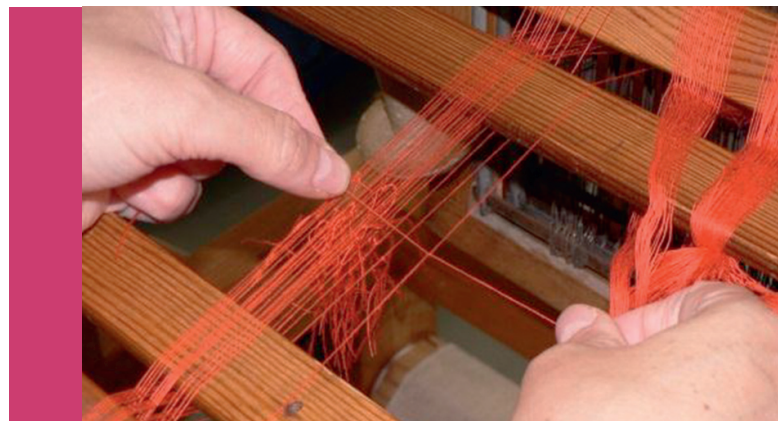
Zwei Ketten mit dem Kreuzknoten verbinden
