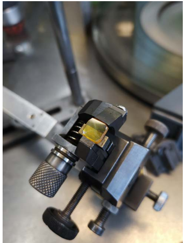
Abbildung 39: Spannvorrichtung mit Diamant © Mildenerger
