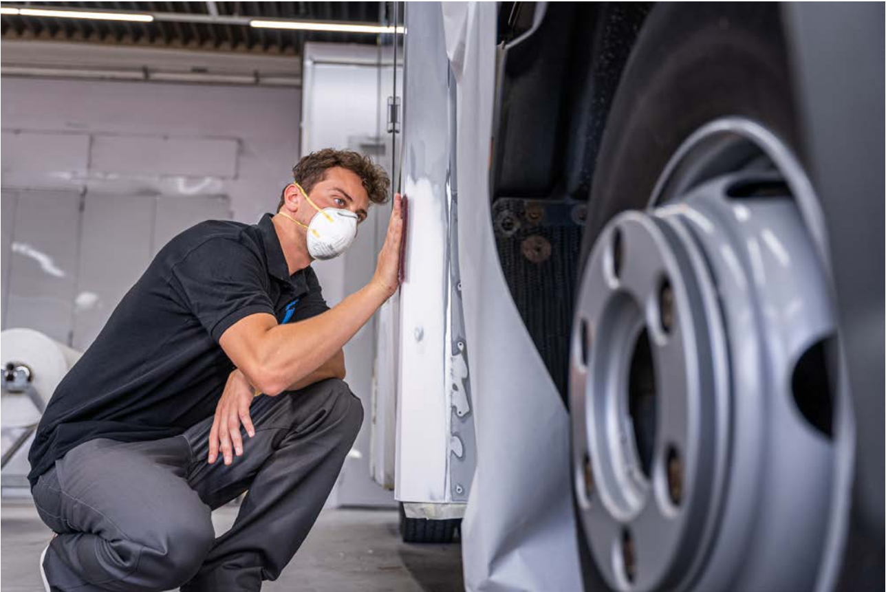
Abbildung 32: Lackvorbereitende Arbeiten an einem Kofferaufbau (Quelle: ZKF)
