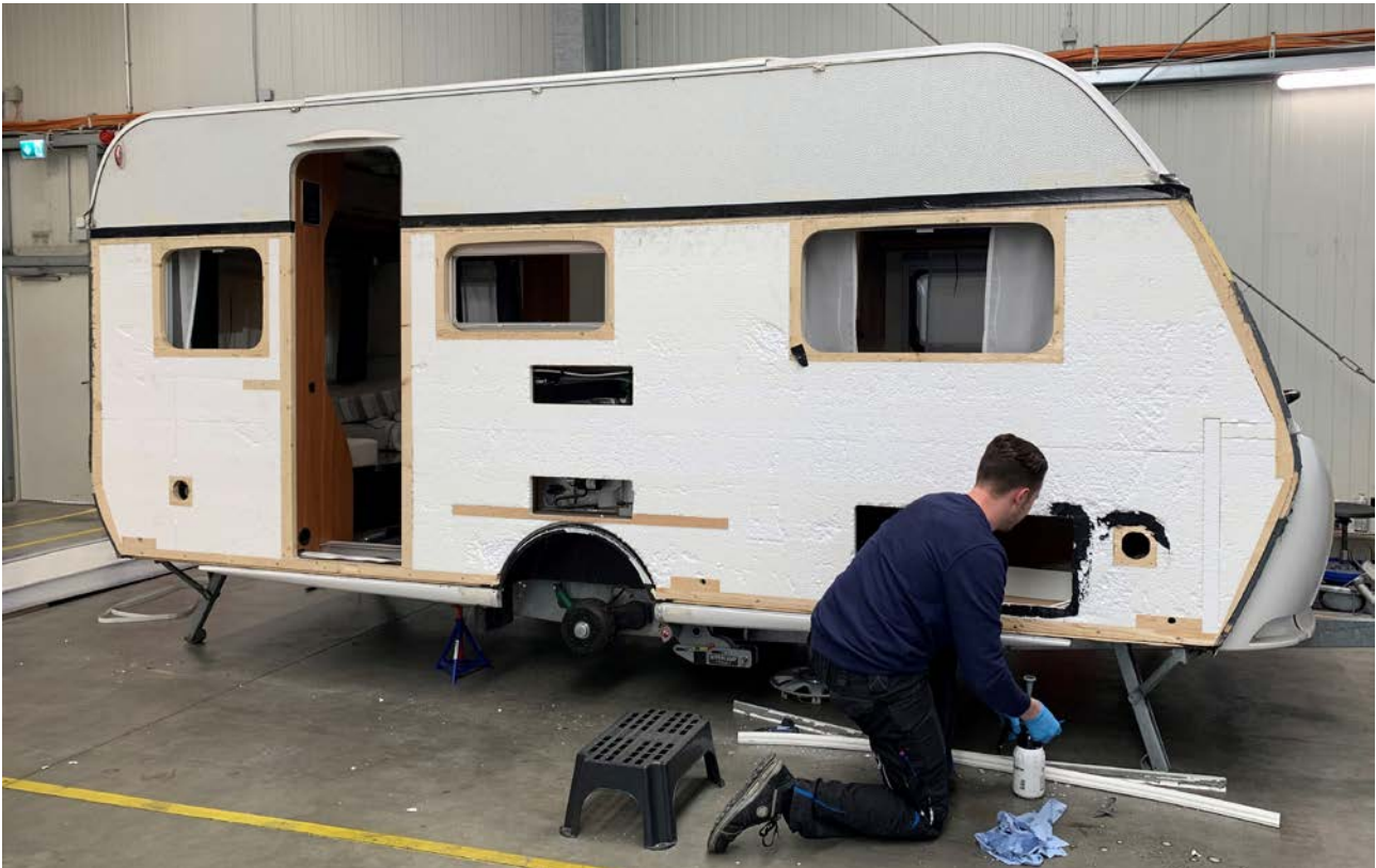
Abbildung 33: Instandsetzungsarbeiten an einer Caravan-Seitenwand (Quelle: P. Lindner, Niesmann Caravaning GmbH & Co. KG)
