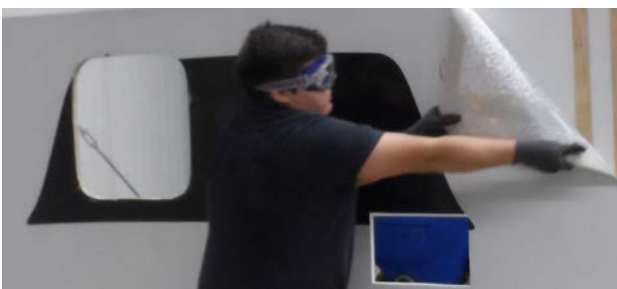
Abbildung 41: Entfernen des Deckblechs an einer Sandwichplatte (Quelle: P. Lindner, Niesmann Caravaning GmbH & Co. KG)
