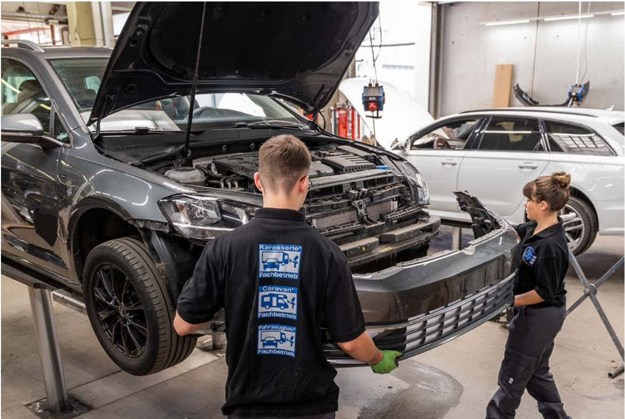
Abbildung 19: Demontage einer Stoßfängerverkleidung in Teamarbeit (Quelle: ZKF)
