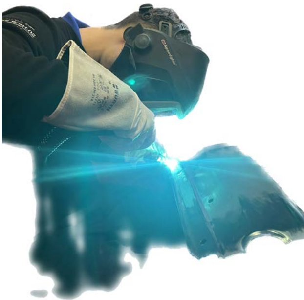
Abbildung 5: Karosserie- und Fahrzeugbaumechaniker/-innen beherrschen die verschiedensten Fügetechniken – hier Metall-Aktiv-Gas-Schweißen (Quelle: ZKF)
