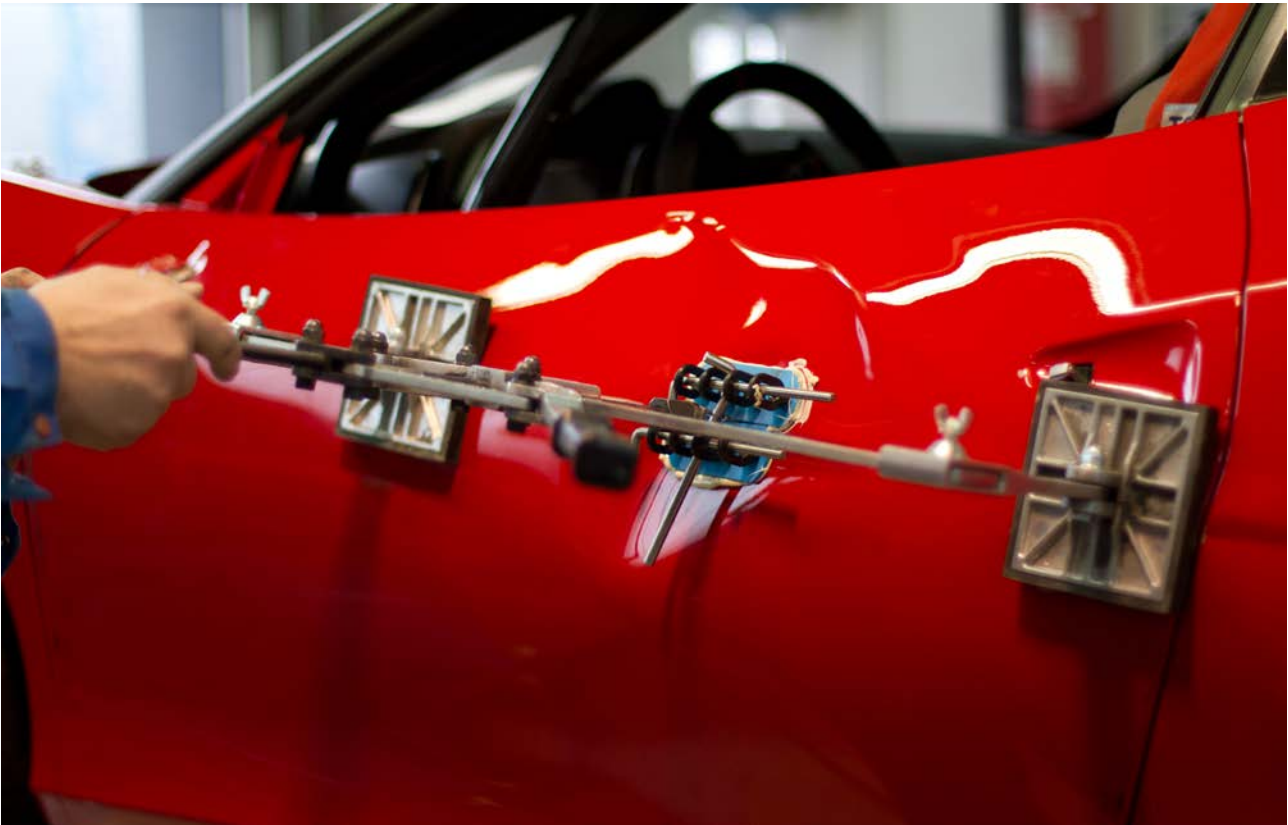
Abbildung 31: Instandsetzung einer Türaußenhaut mittels Flächenausbeul-System (Quelle: ZKF)
