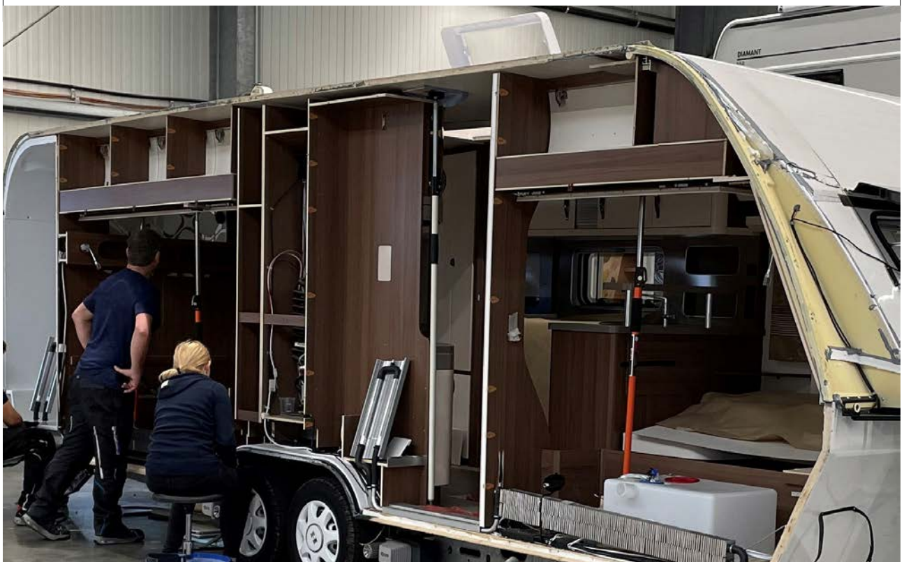
Abbildung 12: Karosserie- und Fahrzeugbaumechaniker/-in in der Fachrichtung Caravan- und Reisemobiltechnik beim Ersetzen einer Seitenwand eines Caravans (Quelle: P. Lindner, Niesmann Caravanning GmbH & Co. KG)
