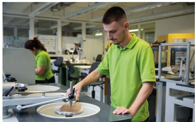
Abbildung 6: Hebelpolierarbeiten (Quelle: DR. JOHANNES HEIDENHAIN GmbH)
