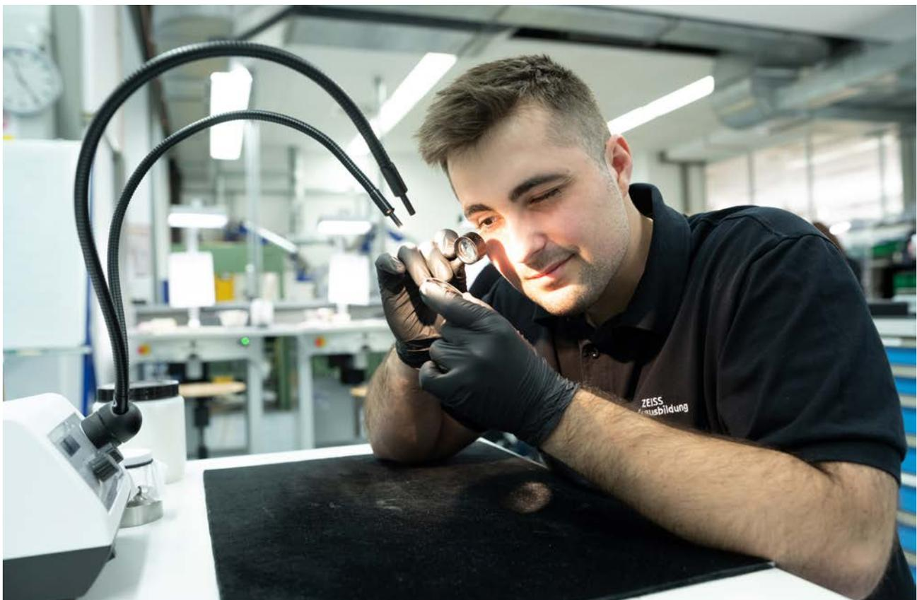
Abbildung 12: Feinoptiker beim Prüfen einer Oberfläche auf Oberflächenfehler (Quelle: Carl Zeiss AG)
