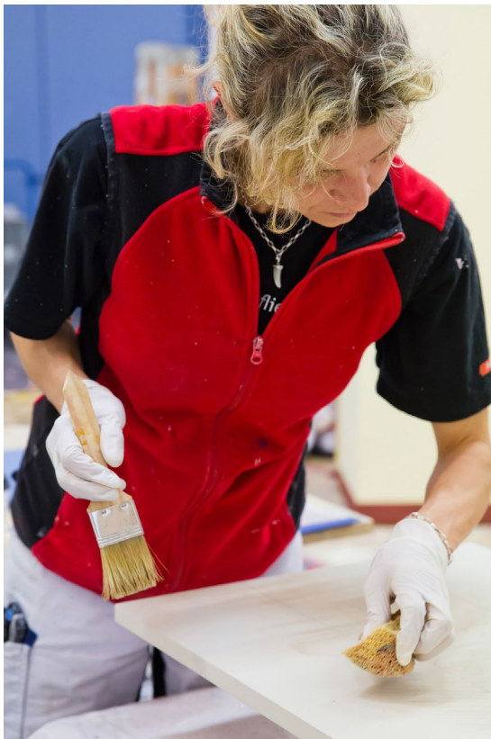
Abbildung 10: Ausführen einer Schwammtechnik (Quelle: Städtische Fachschule für Farb- und Lacktechnik München)
