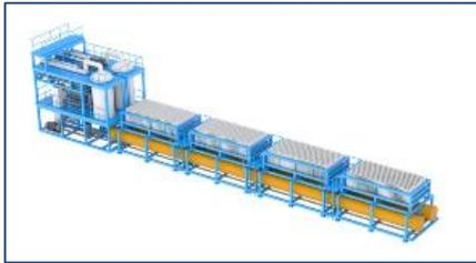
Ausgereifteste Technologie, die eine flüssige alkalische Elektrolytlösung und eine einfache Membrane verwendet.
