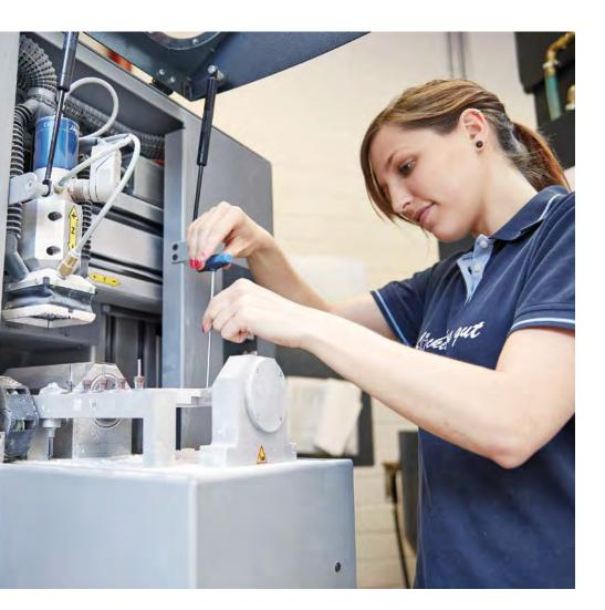
Eine Auszubildende richtet einen Rohling im geöffneten "Blankhalter" ein. Hiermit wird eine Krone gefertigt.
