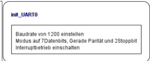
Abbildung 3: Struktogramm - init-UART0 Funktion
