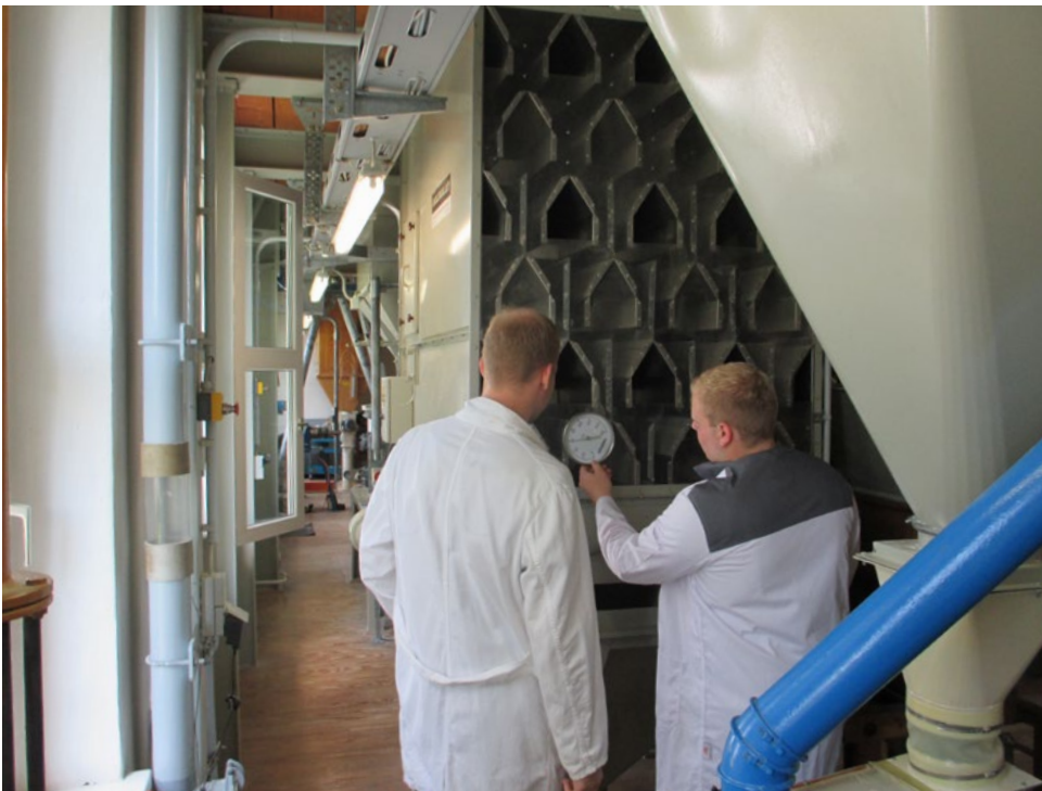
Abbildung 18: Temperaturkontrolle am Dächertrockner (Müllerschule Wittingen)
