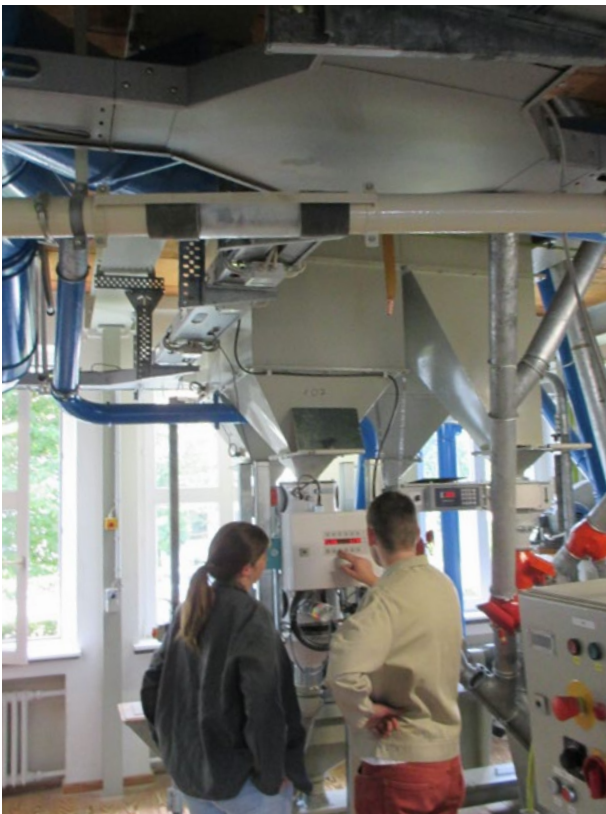
Abbildung 4: Mengendosierung mittels Flowbalancer (Müllerschule Wittingen)
