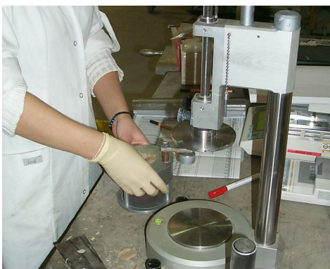
Abbildung 5: Plastizitätsbestimmung nach Pfefferkorn (Foto: FGK)
