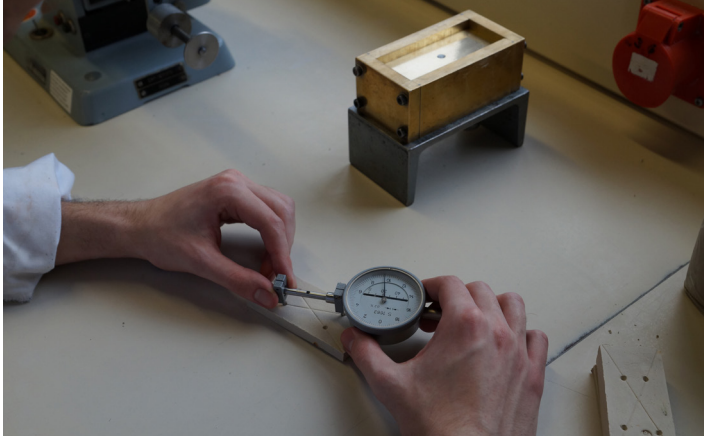
Abbildung 3: Schwindungsmessung mithilfe einer Messuhr (Foto: FGK)
