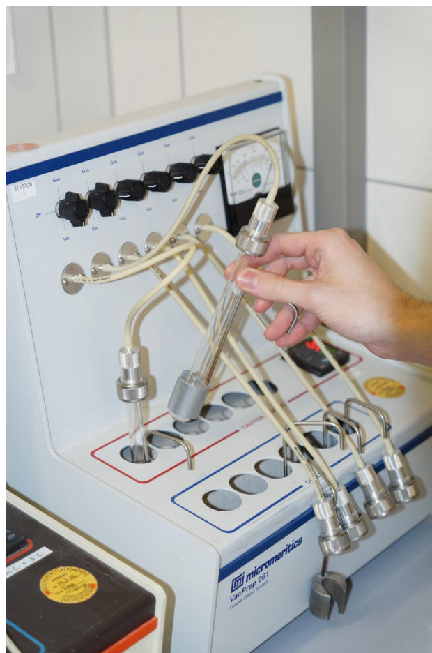
Abbildung 1: Bestimmung der spezifischen Oberfläche nach Brunauer, Emmett und Teller (Foto: FGK)
